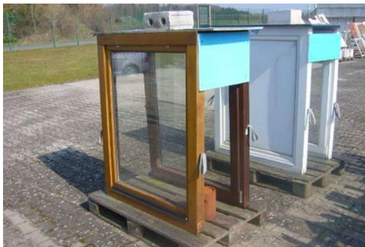
Die Prüfstände nach 10 Jahren Exposition
